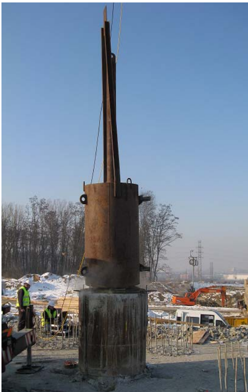
Rys. 2. Widok aksonometryczny stanowiska do próbnego obciążenia statycznego.
