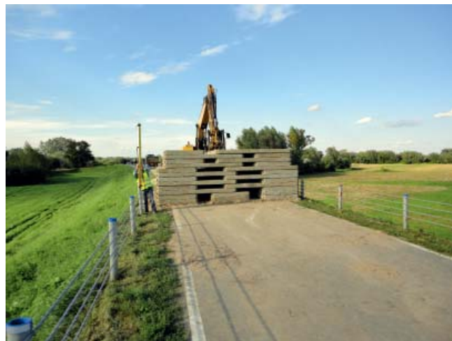
Fot. 5. Próbne obciążenie nasypu drogowego – wału przeciwpowodziowego
