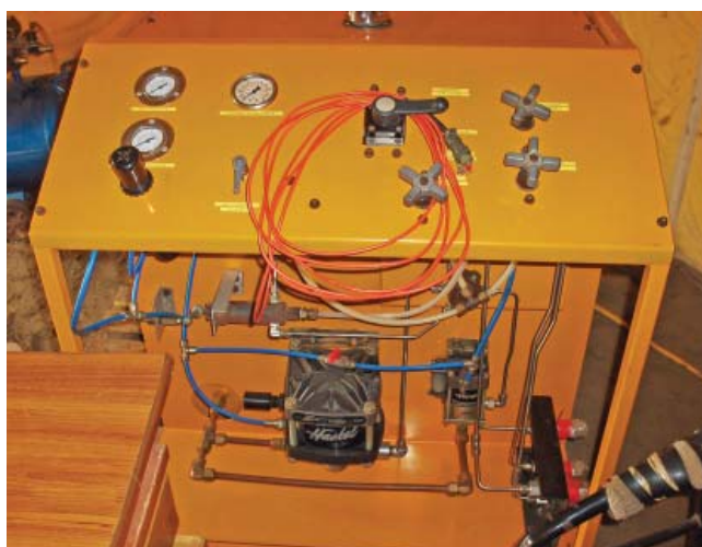
Fot. 8. Automatyczne utrzymywanie siły pompą hydrauliczną sterowaną komputerowo.
