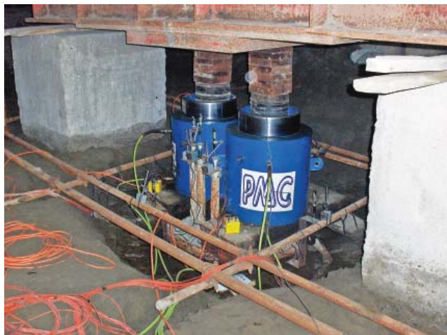
Fot. 2. Zinstrumentalizowany test 30 000 kN
