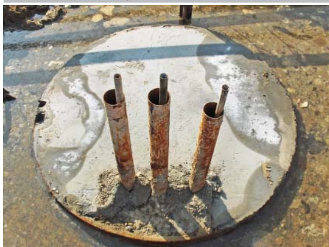
Fot. 3. Ekstensometry w palu gotowym do badań
